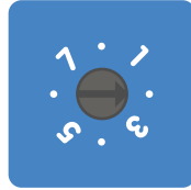
Roterande brytare inställd på position 2
