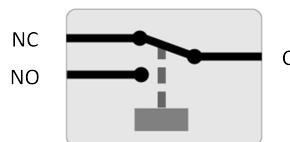
Reläkonfigurering (ej försett med ström).
